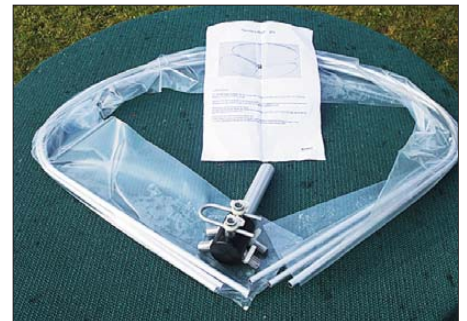
Bild 3: Die Big-Wheel-Antenne für 2 m von [4] besteht aus einem Mittelteil nebst Abgleichbügel sowie drei Schleifenelementen.
