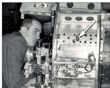
Bild 3: K6GSJ bei Arbeiten an der Oberstufe der Thor-Agena-A-Rakete; man erkennt den Transportraum für OSCAR-1 und den Auswurfmechanismus.
