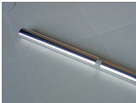
Bild 2: Bewickeltes Kunststoffrohr; Trennstellen lassen sich nachträglich mit einem scharfen Messer herstellen.
