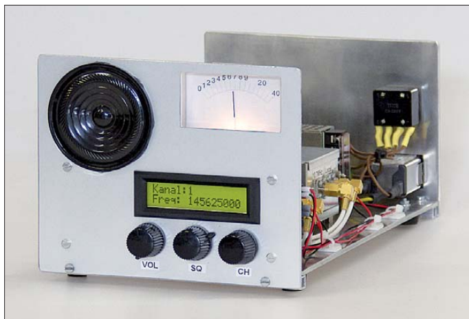
Bild 1: 2-m-FM-Empfänger im eingeschalteten Zustand und mit abgenommenem Gehäusedeckel; im Inneren des Gerätes ist eine der beiden geschirmten Baugruppen zu erkennen, dahinter befindet sich das Netzteil.
