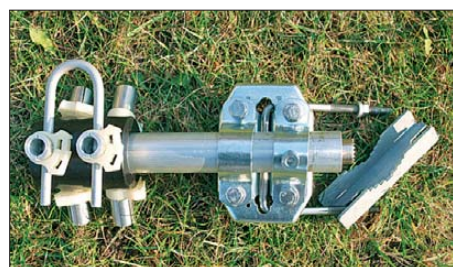
Bild 4: Das 2-m-Mittelteil von [4] besitz von Hause aus keine Befestigungsmöglichkeit, was flexibler ist, aber Kreativität erfordert.
