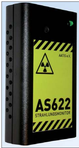
Ein Geigerzähler, realisiert mit einer Fülle neuer Ideen; so reicht eine 1,5-V-AA-Batterie zur Erzeugung der Hochspannung aus.
