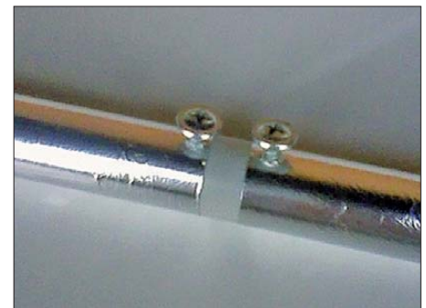
Bild 3: Die Kontaktierung kann wie hier über Schneidschrauben oder mit Nieten erfolgen. Fotos: DO1CEP
