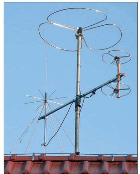
Bild 2: Die 2-m-Big-Wheel auf der Mastspitze und die zwei gestockten 70-cm-Big-Wheels vorn rechts am Ausleger; hinten die Discone-Antenne D-130N [1]
