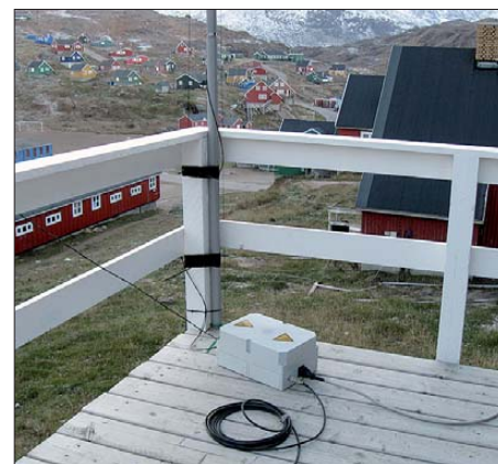
Antennentuner und Mastfuß auf der Terrasse unserer Lodge, bevor sie zuschnitten
